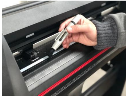
Figura 8.1 Limpieza en área de rodillos.
