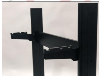
Figura 3.6 Soportes de cilindro fijos a la columna.
