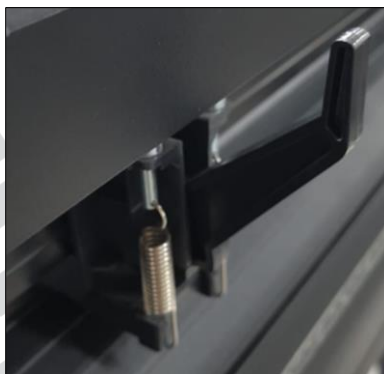
Figura 7.1 Palanca de rodillo de presión.
