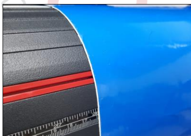
Figura 7.2 Alineación de vinil con cinta métrica.
