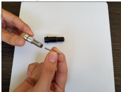
Figura 8.2 Después de desenroscar la porta navajas.
