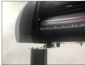
Figura 3.9 Patas del plóter dentro de los orificios.
