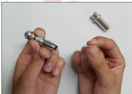
Figura 3.13 Muestra de cómo se debe introducir la navaja.
