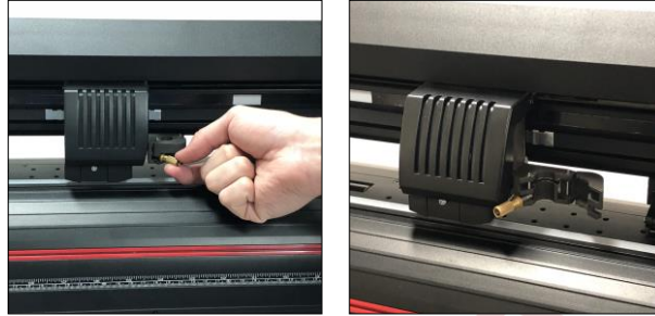
Figura 3.15 Proceso para abrir sujetador (izquierda a derecha).
