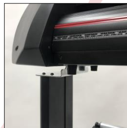
Figura 3.9 Patas del plóter dentro de los orificios.
