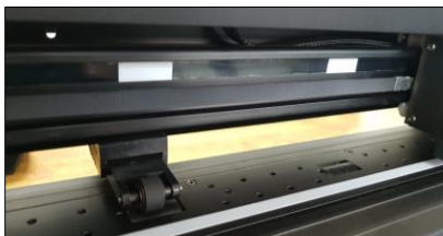
Figura 7.3 Marca de área donde debe colocar el rodillo.
