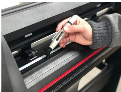
Figura 8.1 Limpieza en área de rodillos.
