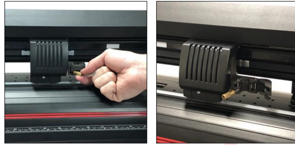
Figura 3.15 Proceso para abrir sujetador (izquierda a derecha).
