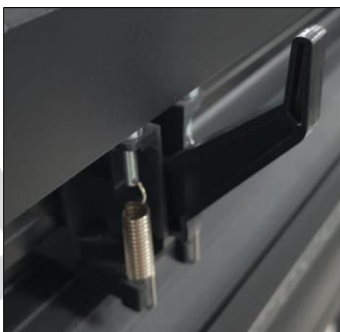
Figura 7.1 Palanca de rodillo de presión.
